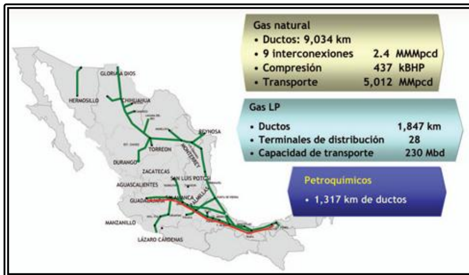
Figura III.1 Cobertura de la Red de Gasoductos en la República Mexicana hasta el 2010.
