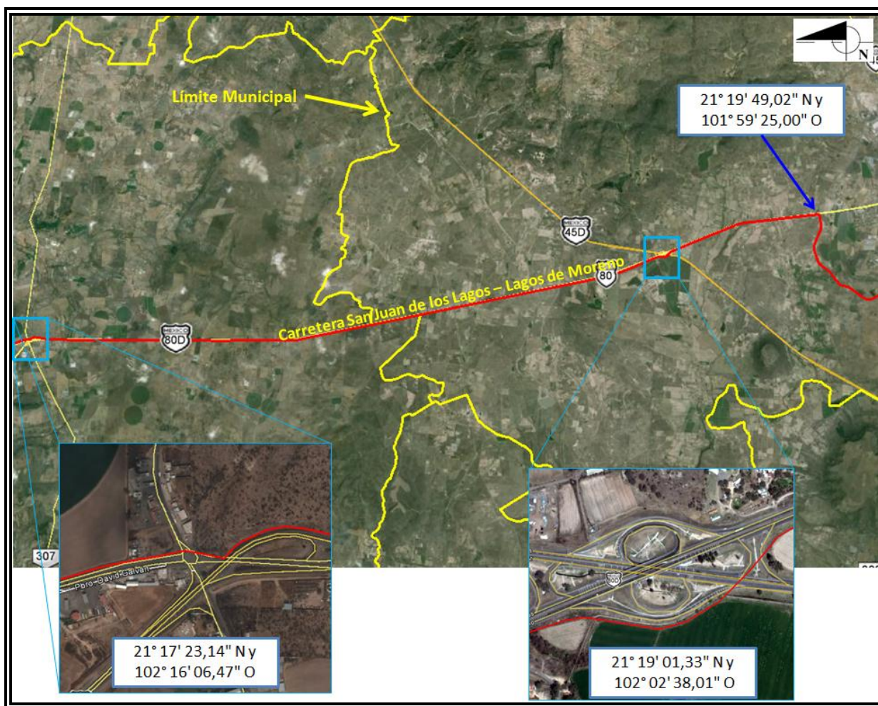
Figura II.1.1.4 Trayectoria del gasoducto de 8”.
